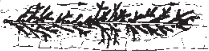
Rauhbaumeinbau mit Pfahlreihen
