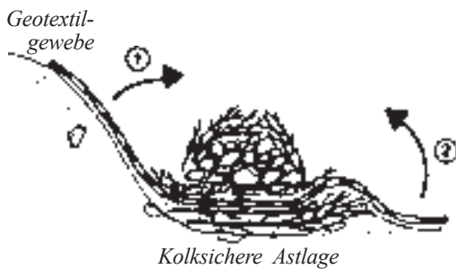
Im Bau befindende Geotextiluferfaschine
